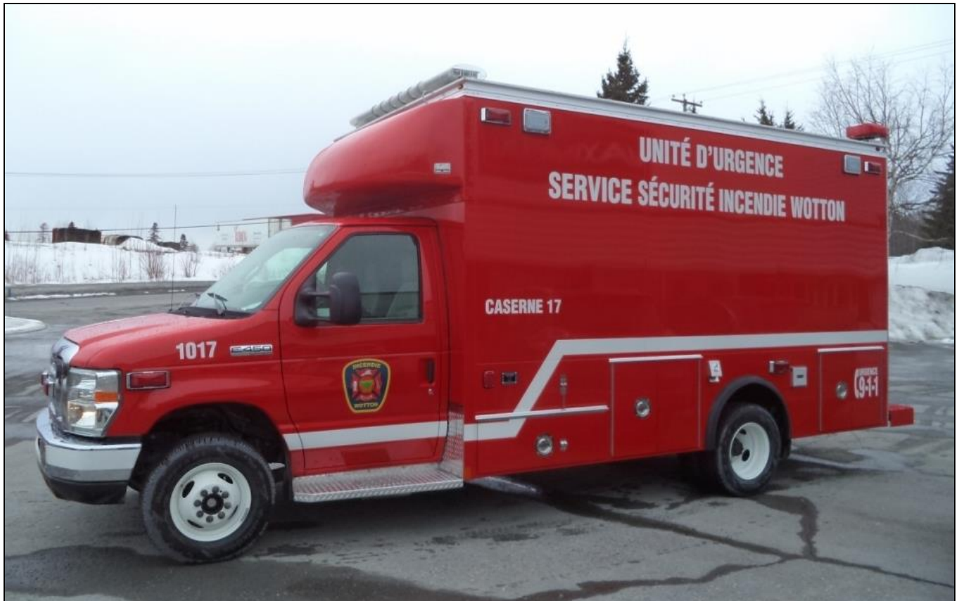
Wotton, QC Unité 1017, a 2018 Ford E-450/Maxi Métal walk-in light rescue, 14.5' box (Photos courtesy Maxi Métal Incendie)
