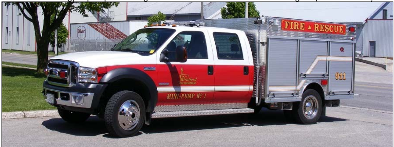
Stratford Mini Pump 1, a 2006 Ford F550 4x4/Rosenbauer, 300igpm/200gwt/25gft.
